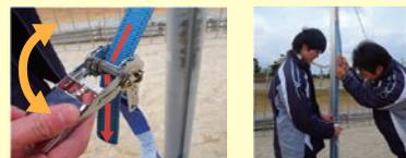
金具にヒモを通してレバーを上下に動かし、締めあげます。
